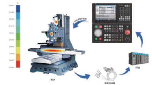
热误差补偿技术基本原理结构图
